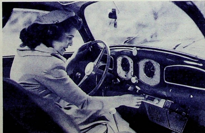
Bild 8. Ein Auto-super, der von Philips hergestellt und in drei verschiedenen Ausführungen geliefert wird. Er besitzt Rimlockröhren und hat Anschluß für Zusatzlautsprecher. Die hier in einem Volkswagen gezeigte Ausführung eignet sich zur Montage unter dem Armaturenbrett
